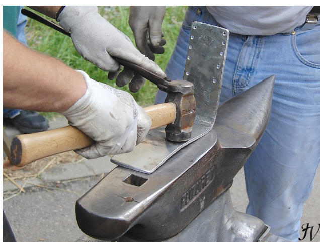
Obr. 17.39. C,D: Zleva - Zaměření potřebné palmární (zadní) extenze a podpory spěnkového kloubu a výroba extenze z hliníkového plechu tloušťky 4 mm.
